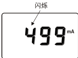
图14. 电流报警临界值设定
